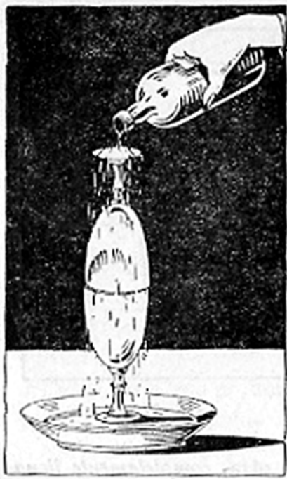
Figura 2. Un dels experiments d'Estalella sobre flotació de vi sobre aigua. Les dues copes estan inicialment completament plenes d'aigua, i s'ha aconseguit posar-les l'una sobre l'altra amb l'ajut d'un cartró, que s'ha retirat després. Es desplacen lleugerament les dues copes de manera que entre elles hi quedi una estreta obertura, per on l'aigua no es buida degut a l'alta tensió superficial que té. En abocar vi negre sobre la copa superior, el vi rellisca al llarg de la copa invertida, i, com que té menys densitat que l'aigua, entra a la copa superior desplaçant l'aigua. En acabar l'experiment es tindrà la copa superior plena de vi —de fet, d'una barreja de vi i aigua, però clarament acolorida— i a la copa inferior s'hi manté l'aigua inicial.
