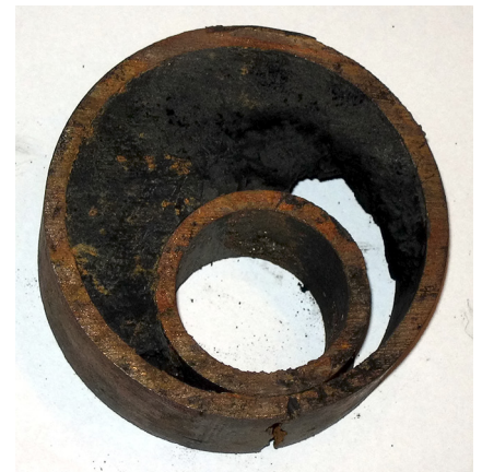
Figura 2. Secció d'un doble tub obstruït.
